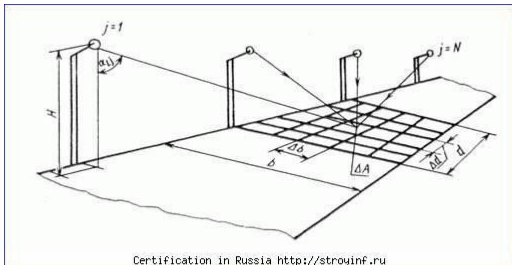
$d$  -длина контрольного участка;  $\Delta d$  -длина элементарной площадки;  $b$  -ширина проезжей части;  $\Delta b$  -ширина элементарной площадки;  $\Delta A$  -элементарная площадка;  $H$  -высота установки светильника;  $\alpha_{ij}$  -угол, ориентирующий направление силы света
